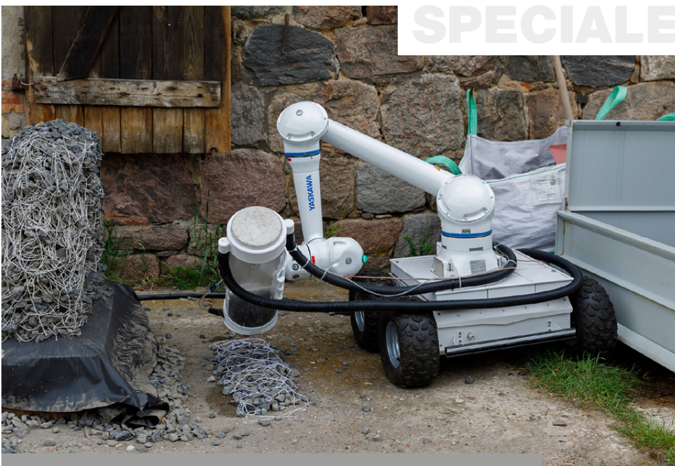
Il cobot Yaskawa HC10DTP ha una capacità di carico 10 kg e protezione IP67
