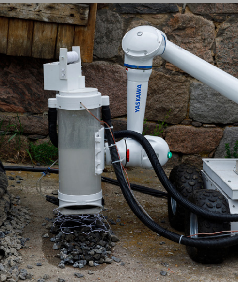
Il cobot Yaskawa HC10DTP ha una capacità di carico 10 kg e protezione IP67
