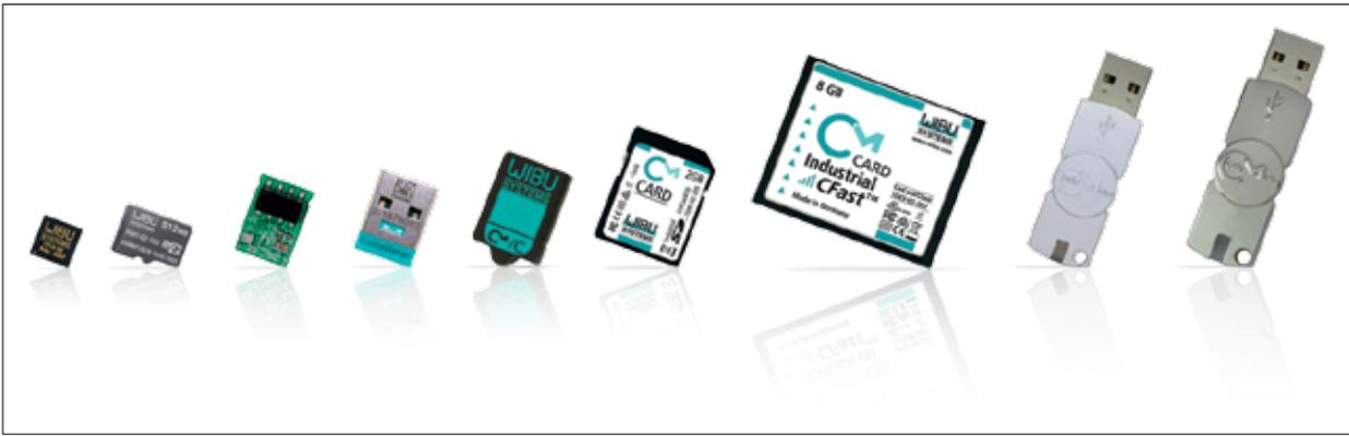
Unterschiedliche Bauformen der Codemeter-Schutzhardware und der softwarebasierten Lösung
