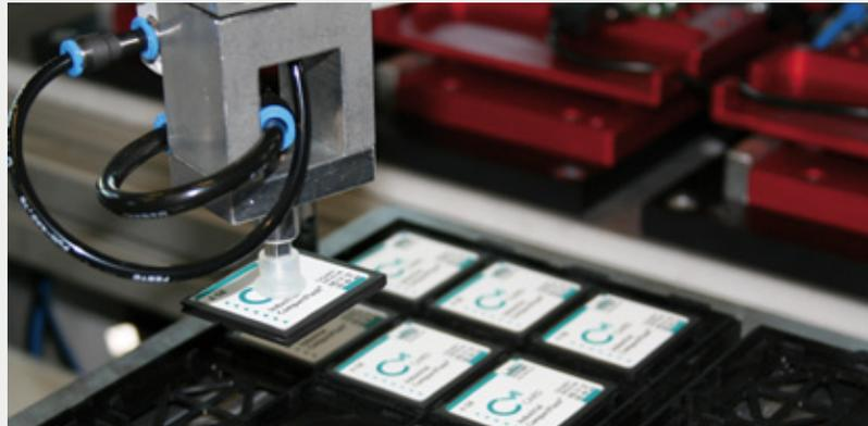
Roboterarm des vollautomatischen Prüf- und Kennzeichnungsautomats mit CodeMeter CmCard/CF
